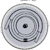
ab Ø 490 zweigeteilte und klappbare Abdeckung (aus PC):
